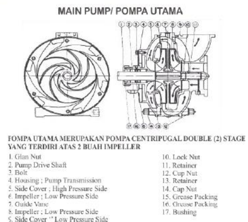
Gambar 3. 1 Pompa Utama/Main Pump
